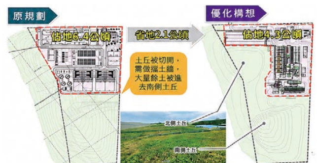
圖 8 新竹海水淡化廠空間配置及製程設計優化
