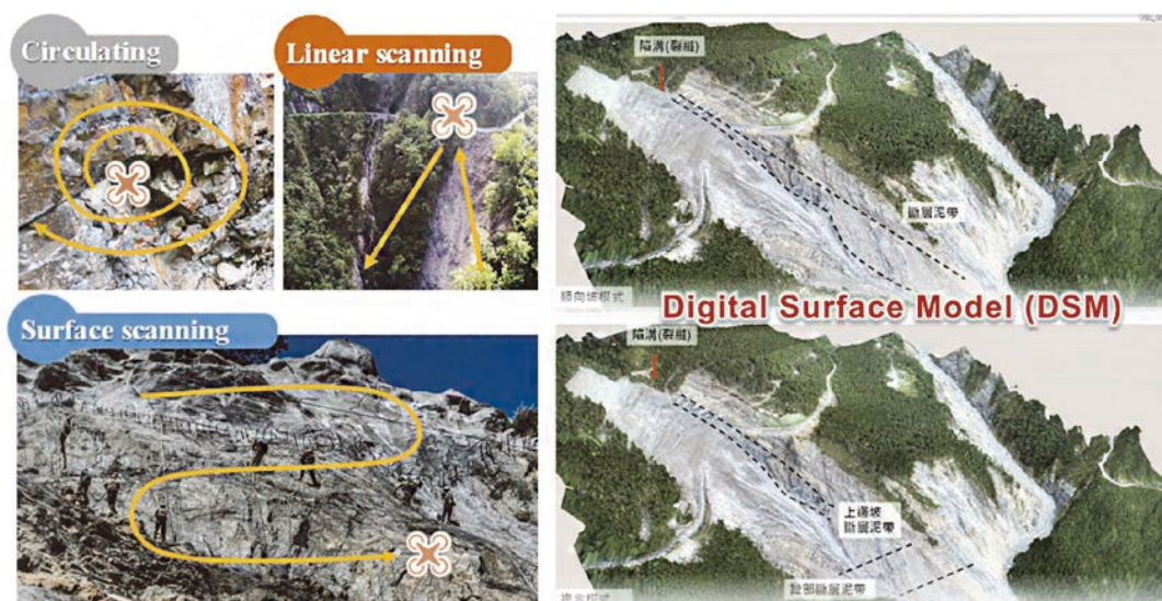
圖 10 UAV 應用於邊坡科技巡檢
