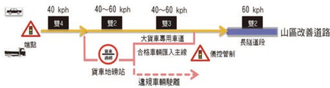
圖 18 大貨車儀控管制系統示意圖
