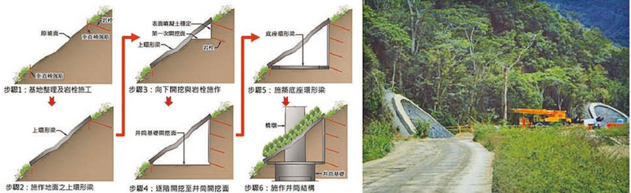
圖 8 井基及竹削工法施工
