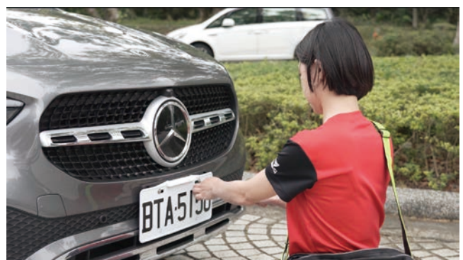
圖 5 新式車牌型 eTag 安裝作業
