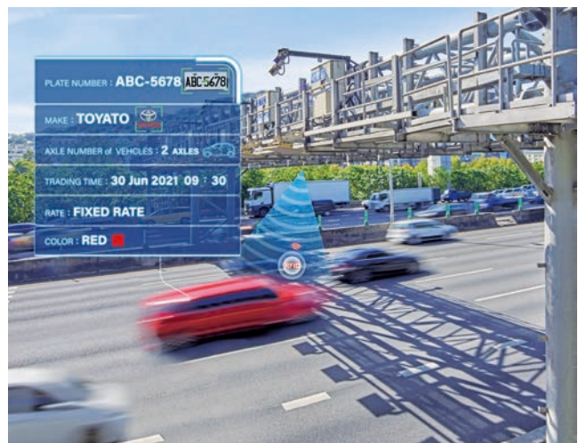
圖 8 車輛行經 ETC 門架互動示意
