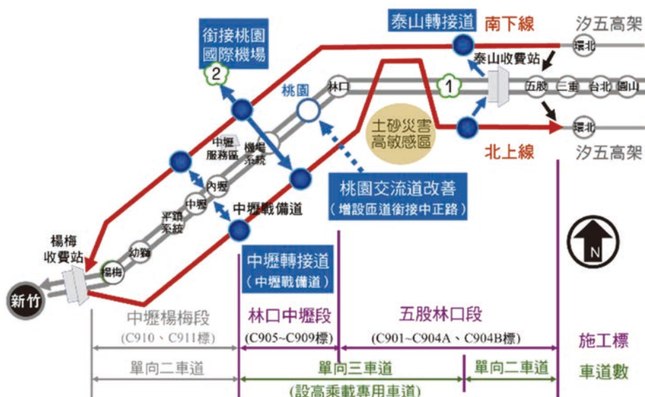
圖 2 各路段車道配置及進出示意
