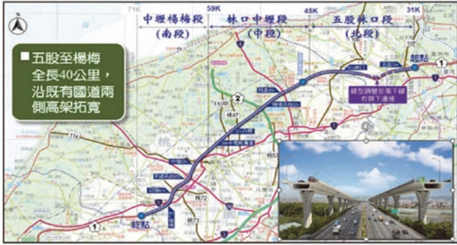
圖 1 五楊拓寬路段及斷面示意
