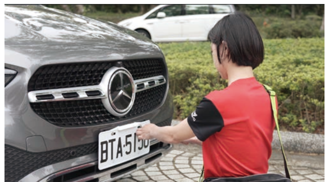
圖 5 新式車牌型 eTag 安裝作業
