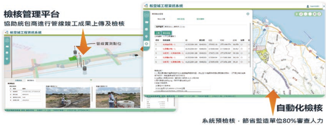
圖 4 地下管線實測資料建檔並自動檢核
