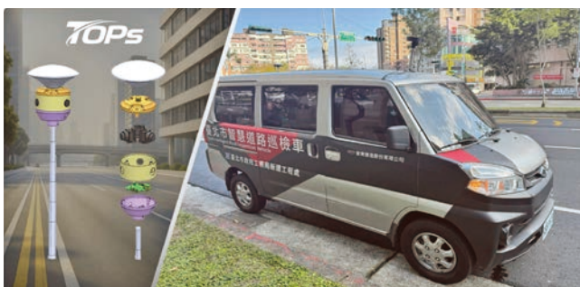
圖 2 TOPs 全景巡檢系統整合於巡檢車輛之實際配置
