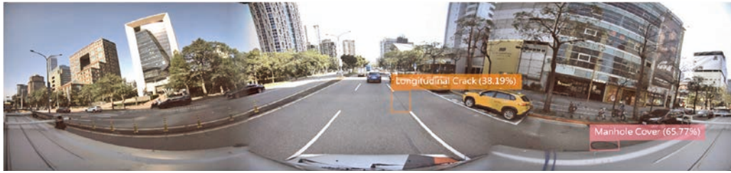
圖 6 於全景辨識裂縫及人手孔
