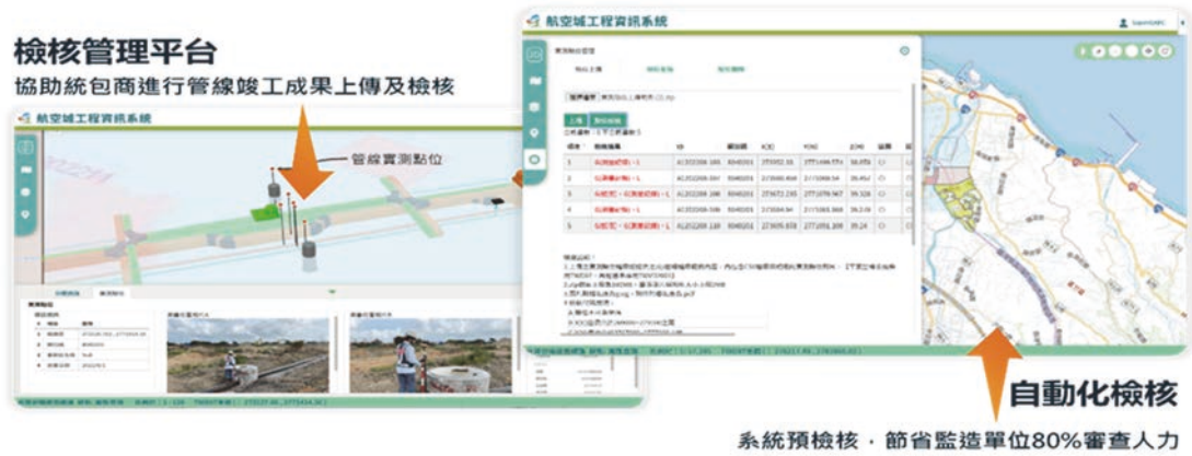
圖 4 地下管線實測資料建檔並自動檢核
