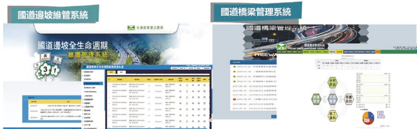
說明：高公局納管橋梁及邊坡基本資料、竣工圖資、歷年之檢（監）測、巡查及養護紀錄，確實掌握橋梁結構、邊坡與設施現況，做為後續維管依據。
