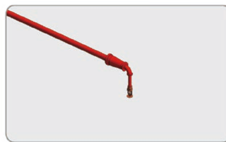
生成結果局部場景 B： 支管、撤水頭與大小頭等元件
