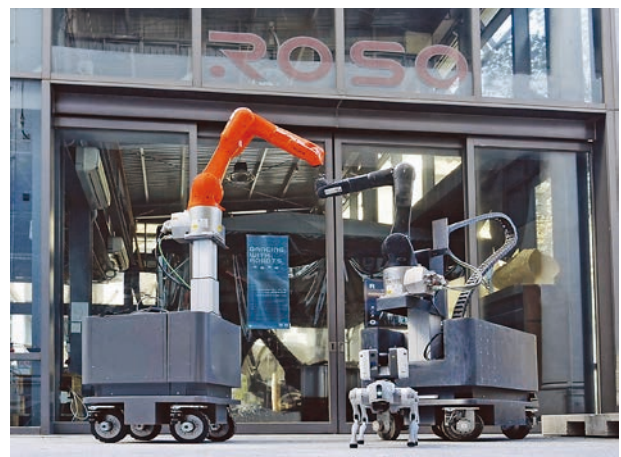
圖 15 ROSO 營建機器人現場施作團隊 （左：黑武士 2 mini 號；中：檢測工地機器人；右：黑武士 2 號）
