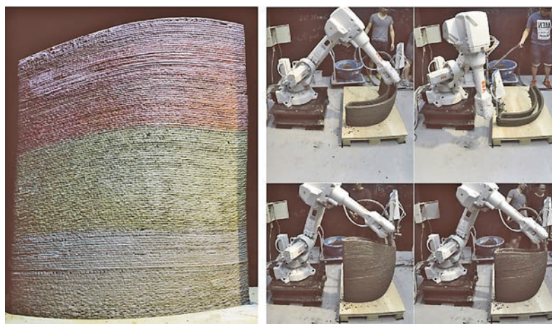
圖 4 機器人水泥 3D 列印自由造型模具
