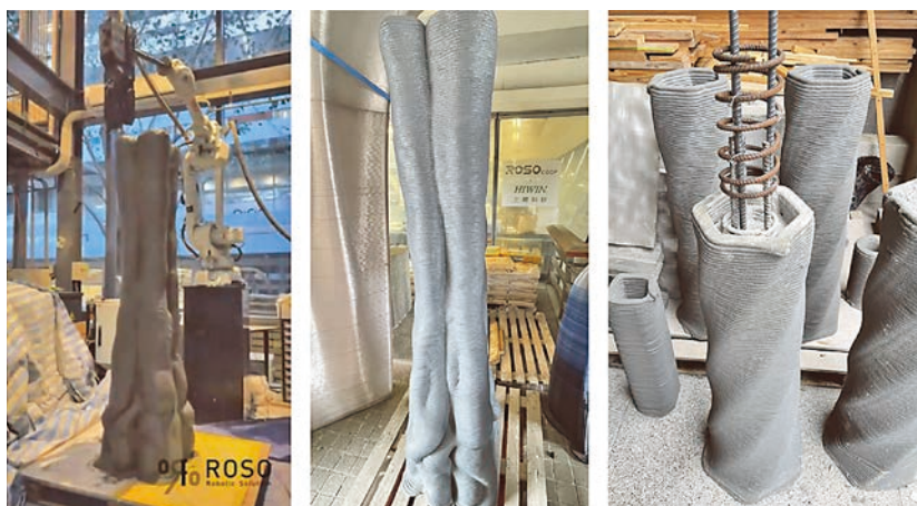
圖 10 作為免拆模水泥列印預鑄柱子的可能性嘗試
