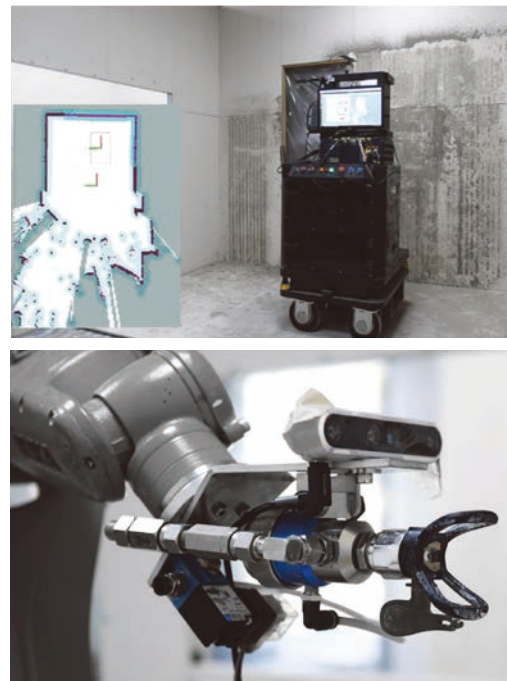
圖 14 （上）黑武士 1 號於實驗室做定位測試； （下）相機跟隨機器人（eye-in-hand）工具頭的模式
