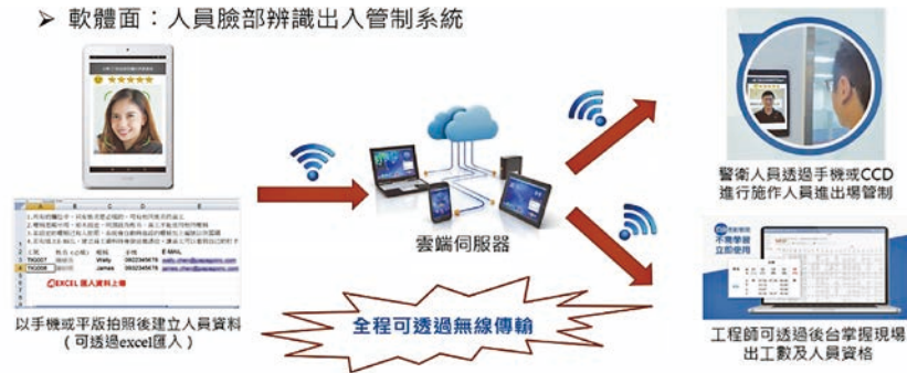
圖 5 臉部辨識出入管制系統架構圖 [3]
