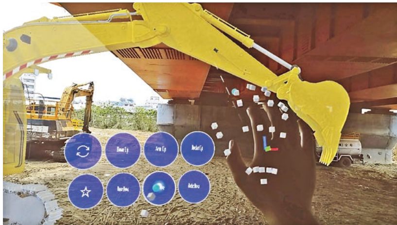
圖 3 以 MR 技術評估機具動線 (圖片來源: 洪偉翔 [15])
