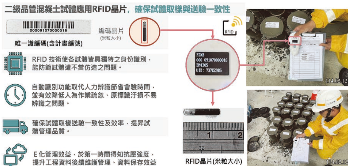
圖 6 應用 RFID 於混凝土試體
