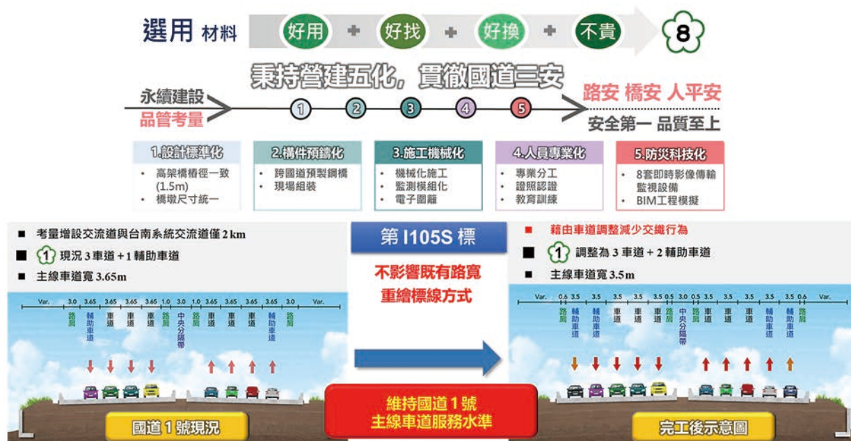
圖 2 現況及完工後車道對照圖
