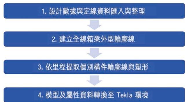
圖 3 鋼箱梁建模流程圖
