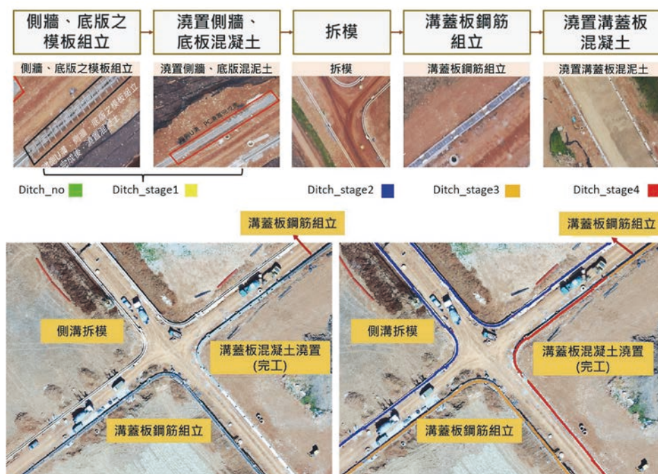
圖 8 道路側溝施作進度評估
