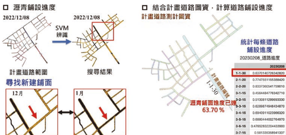
圖 10 瀝青鋪設進度辨識
