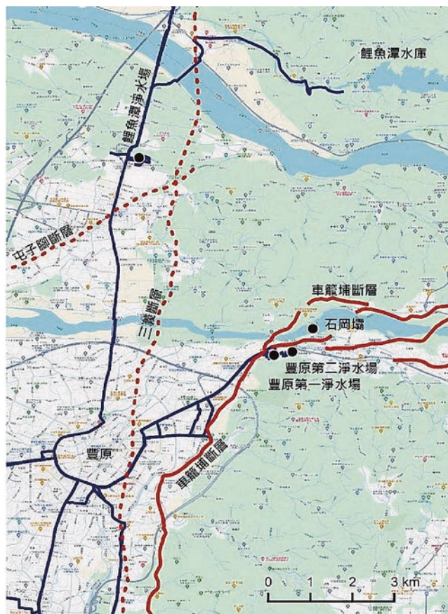
圖3 大台中地區雙水源之上游管線設施與鄰近斷層分布情形
