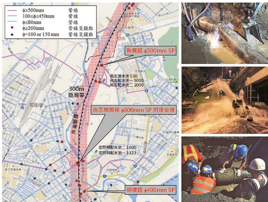
圖 6 2018 年花蓮地震米崙斷層帶上供水管線震害分布情形（照片由台水公司提供）
