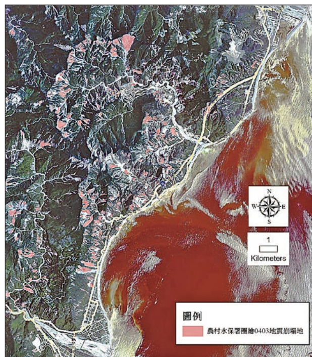
圖 2 和平至崇德間圈繪之地震邊坡破壞位置
