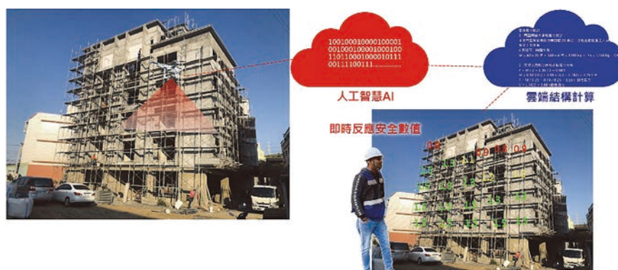
圖 14 人工智慧 AI + 即時結構運算應用於營造工地供工程師決策之構想圖
