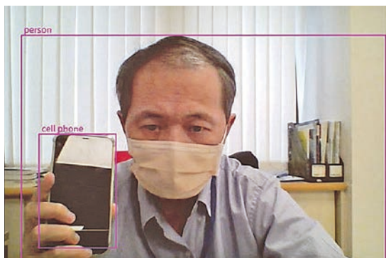
圖 11 引用原節點包進行影像物件偵測：人與手機
