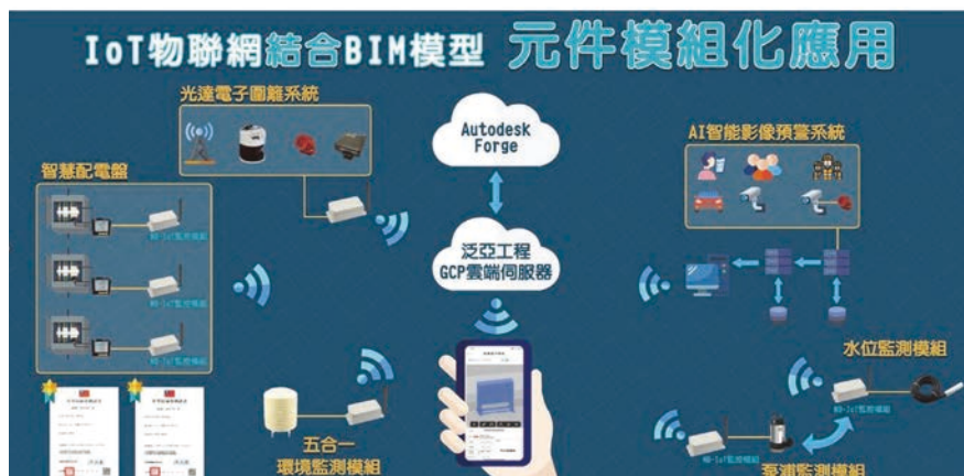
圖 10 IoT 物聯網結合 BIM 模型元件模組化應用系統架構圖
