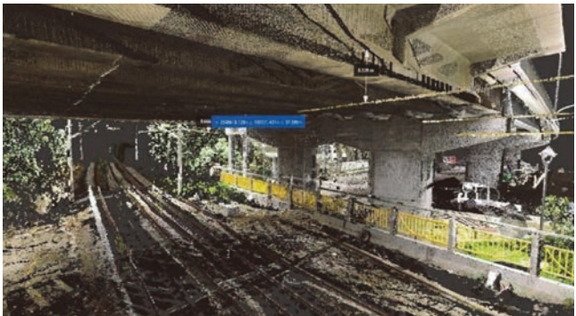
圖 13 嘉義鐵路高架化前期工程 C602 標施工前點雲模型檢測成果
