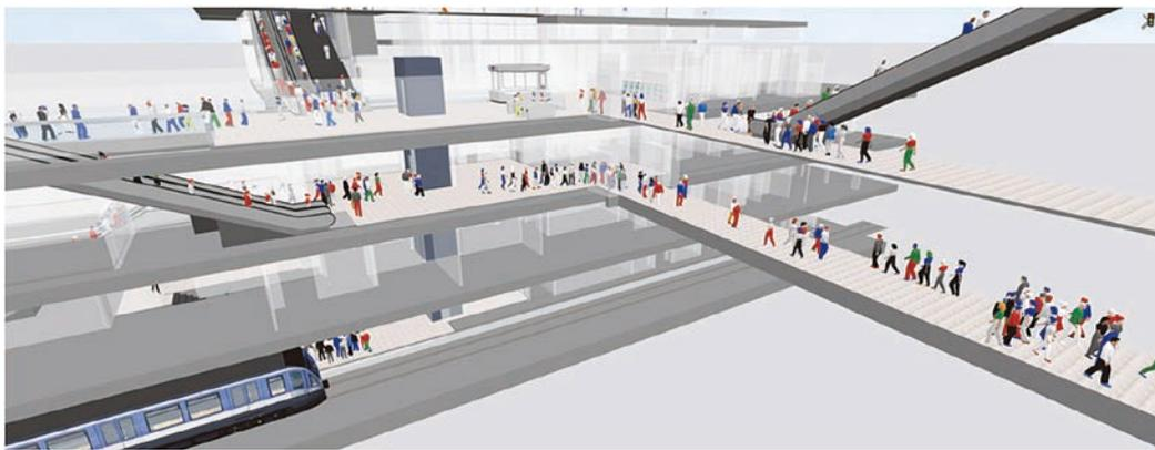
圖 2 BIM 結合人流模擬分析示意圖
