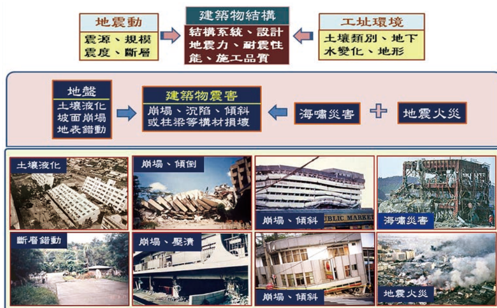
圖 7 建築物震害之影響要因與震害現象
