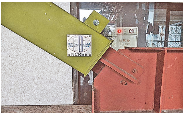
圖 16 BRB 150tonf 級單管單核心槽接式挫屈束制支撐 「國家地震工程研究中心－槽接式挫屈束制支撐專利」
