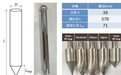
圖 7 試驗用縮尺模型錨
