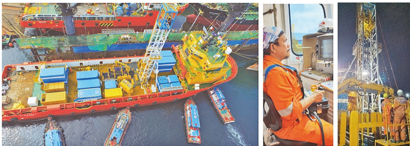
圖 6 大地能源號搭載之塔架式鑽機設備
