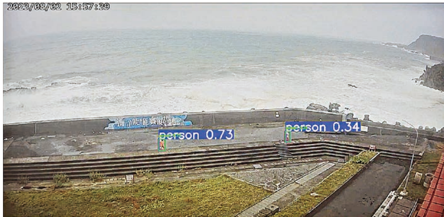
圖 6 以 YOLOv5 偵測 CCTV 畫面中的人員，圖為海洋大學工學院後方海堤
