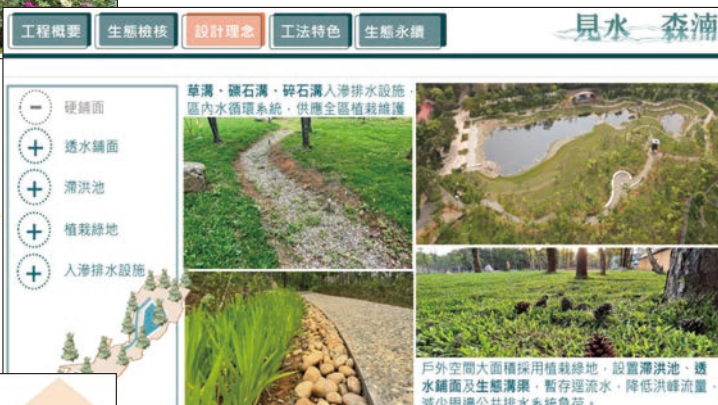
廣設草溝、碎石溝及透水鋪面，減少混凝土之使用。
