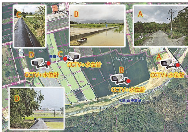
圖 8 過路窩橋在地滯洪示範區壓力式水位計、CCTV 安裝位置
