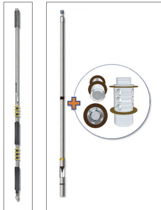
圖 31 (a) 芬蘭 POSIVA 製作之整合式封塞流速儀 (最小量測區段為 25 cm); (b) 熱脈衝流速儀之封塞水流分離裝置 (最小量測區段為 10 cm)
