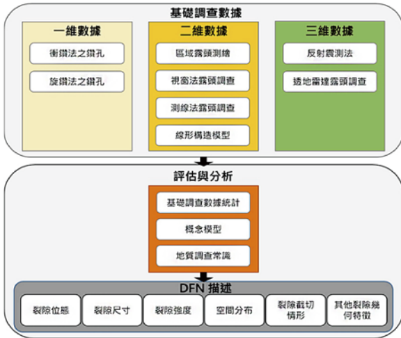
圖 6 建立離散裂隙網路模式之調查數據與生成參數項目 資料來源：重繪自 Munier [18]
