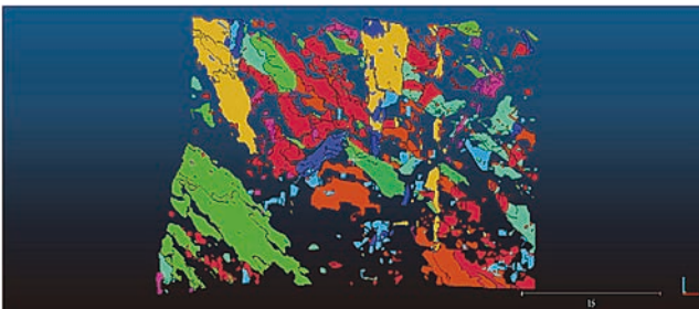
圖 27 利用三維點雲資料進行裂隙面萃取之成果示意圖
