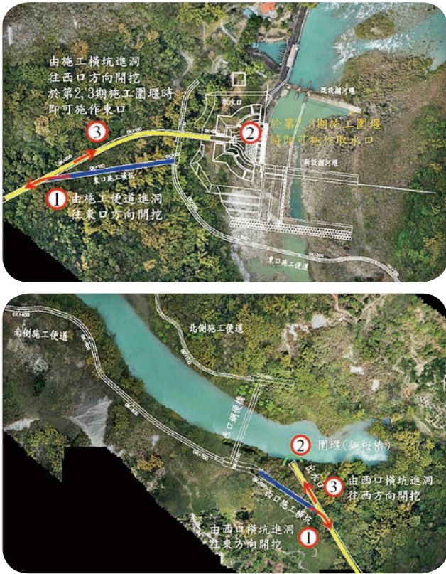
圖 6 施工橫坑交叉段順接設計
