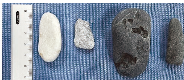
圖 7 室內粒徑判釋試驗所採用的礫石材料
