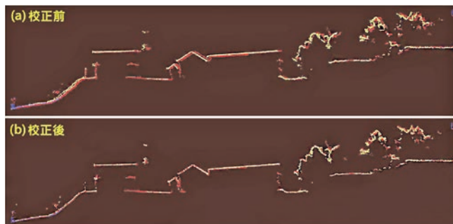
圖 9 點雲資料經航線平差修正前後說明例
