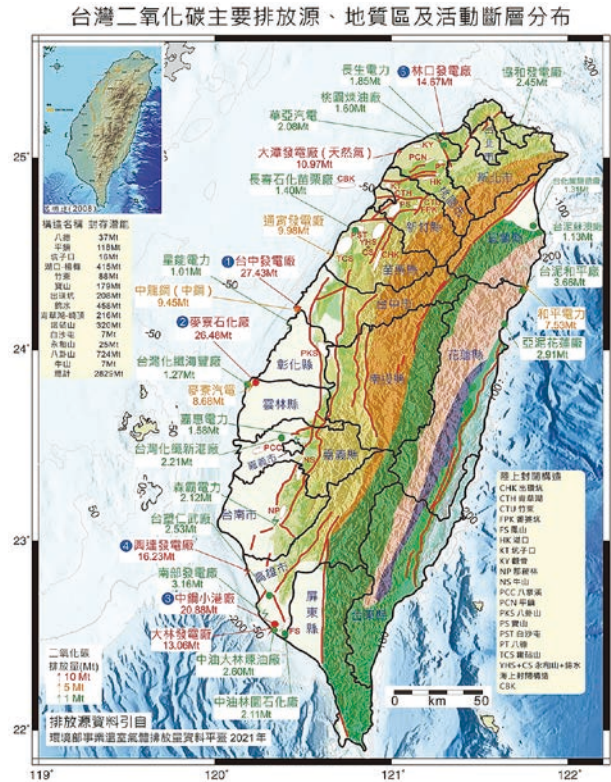
圖3 台灣陸地地質圖、活動斷層(紅色線段)及海域水深圖。活動斷層分布根據林啟文等 [8] ，圖中顯示二氧化碳主要排放源及2021年之年度排放量(排放量依據環境部事業溫室氣體排放資訊平台資料 [7] ，單位：百萬噸Mt)。陸上與海域封閉構造以白色橢圓形表示，其圖說見圖之右下方。圖左上方表列呂明達等人 [9] 所計算之14個陸上封閉構造名稱及封存量(單位：百萬噸Mt)。
