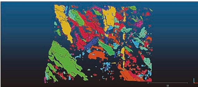
圖 27 利用三維點雲資料進行裂隙面萃取之成果示意圖
