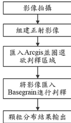
圖 2 使用 BASEGRAIN 粒徑判釋流程
