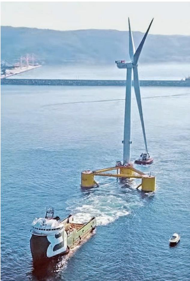
圖 10 Windfloat Atlantic 浮式風場之錨索牽引補給船施工案例<sup>[27]</sup>
