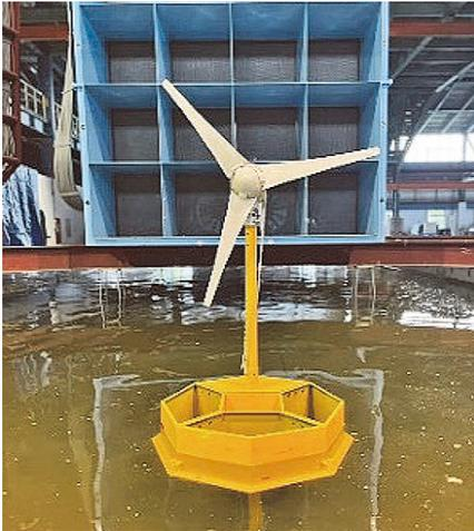
圖 14 在成大水工所進行 Orein 浮式風機平台試驗
