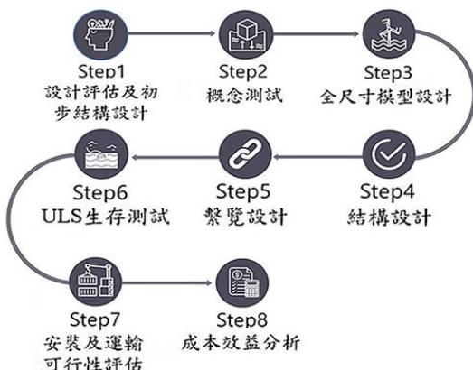
圖 1 浮式風機平台設計流程圖
