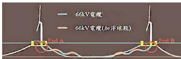
圖 16 浮式機組間動態電纜配置圖
