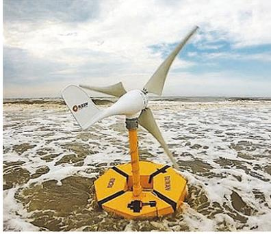
圖 18 我們的風機平台在海上漂浮及發電情形
