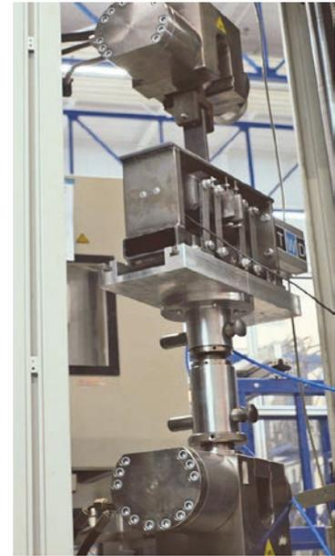
圖 4 摩擦測試儀器 [3]
