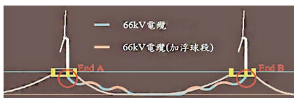
圖 16 浮式機組間動態電纜配置圖
