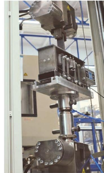
圖 4 摩擦測試儀器 [3]
