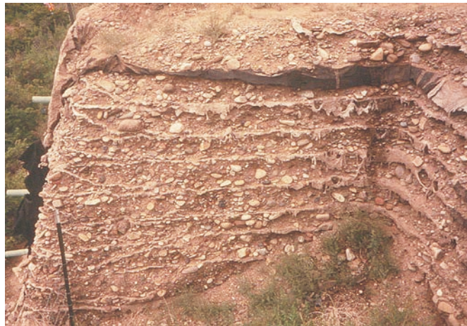
Glenwood Canyon 試驗加勁路堤即使局部破壞，結構體仍能自立
