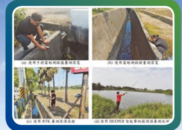
現地量測取得排水渠道斷面及 埤塘深度相關資料
