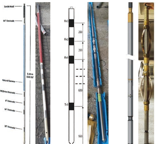
圖 8 三種井測儀器示意圖及實體照片
