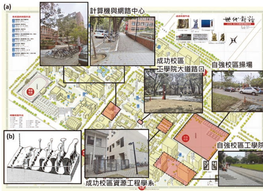
圖 2 國立成功大學建築物破壞分布位置圖（底圖取自 2009 年成大校園環境藝術節校園分布圖）。(a) 建築物破壞分布位置（紅色方框）與對應之照片。(b) 泥貫入體發育模式 [20] 。
