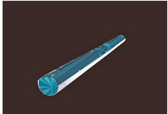
圖 7 將連續的 XCT 圖重建為三維岩芯模型 (資源系 BH-1 研究井 10~11 m 岩芯)
