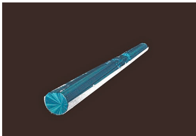
圖 7 將連續的 XCT 圖重建為三維岩芯模型 (資源系 BH-1 研究井 10~11 m 岩芯)
