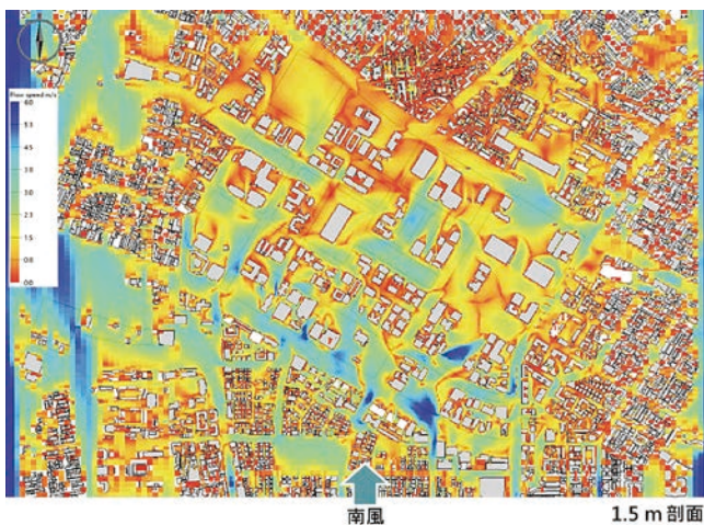
圖 5 新市政中心專用區 CFD 氣流模擬分析成果 [9]
