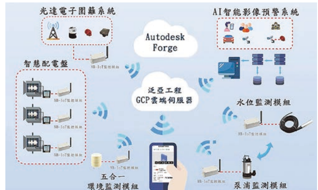
圖 12 泛亞工程公司「IoT 與 BIM 模型元件模組化預警系統」架構圖
