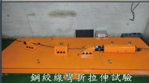
鋼絞線彎折拉伸試驗
