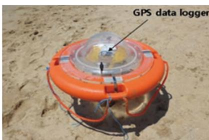
圖 3 海雲台海灘測量裂流之 GPS 浮標 [19]
