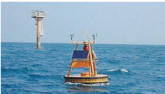
圖 3 海氣象資料浮標（前景）與海氣象觀測樁（遠景）
