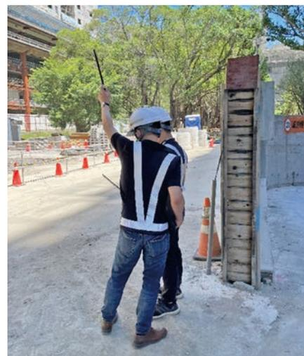
圖 6 LoRa 信號傳送 / 接收實測
