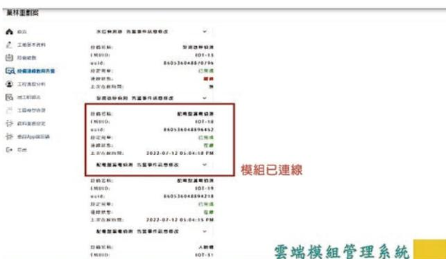
圖 15 後台物聯網模組偵測到 NB-IoT 模組訊號後連線成功
