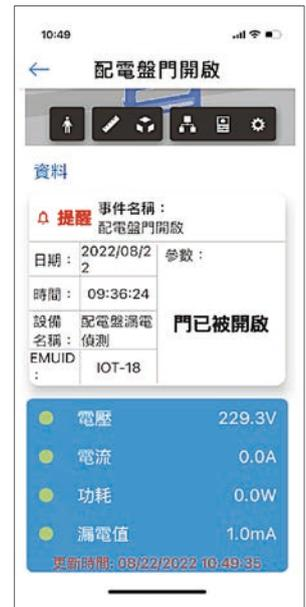
圖 17 配電盤即時電壓、電流、功率及漏電值訊息 (漏電值大於 30 mA 會再另跳告警訊息)
