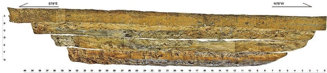
圖 6 槽溝南牆面地質剖面圖
