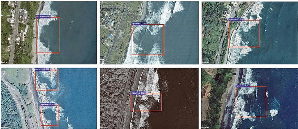
圖 12 模式裂流辨識結果圖。圖中紅框處代表模式辨識裂流發生的位置
