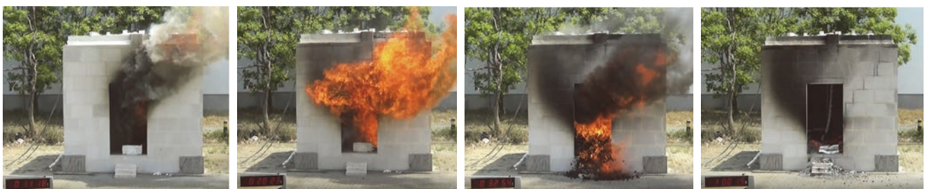
(a) 閃燃 (b) 完全燃燒 (c) 木材倒塌 (d) 停止燃燒
