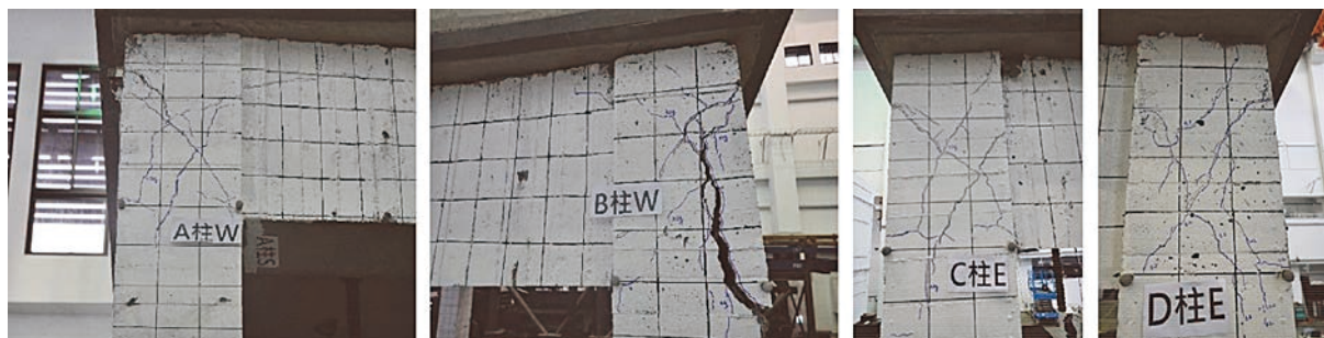
圖 15 NF 試體梁柱接頭剪力破壞（TCU063，PGA = 0.2 g）
