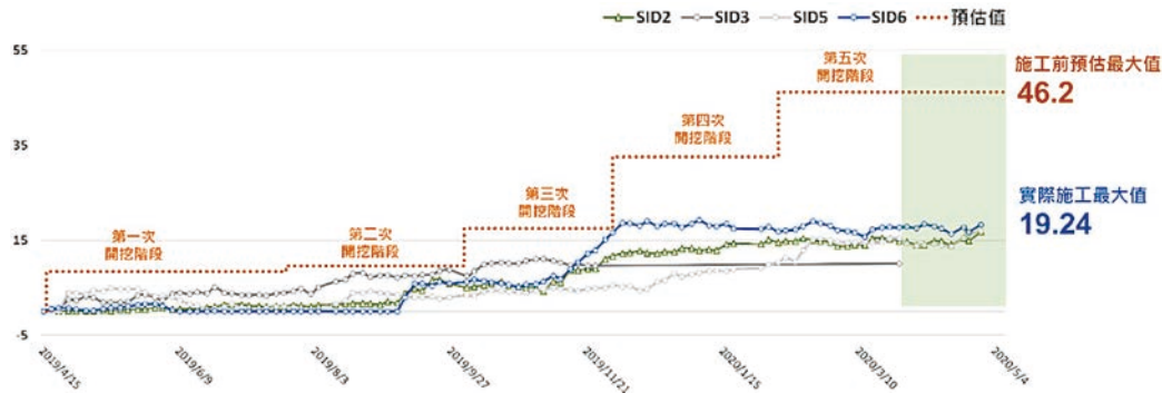
圖 18 各階段開挖實際監測值與施工前評估值歷時曲線圖資
