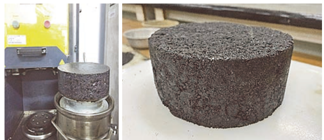
圖 12 旋轉揉搓壓實儀（SGC）與漢堡輪跡試體 [7]
