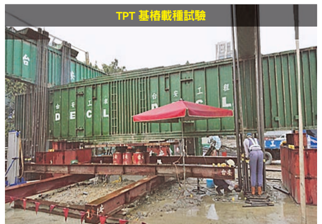
圖 11 現地場鑄基樁載重試驗圖資
