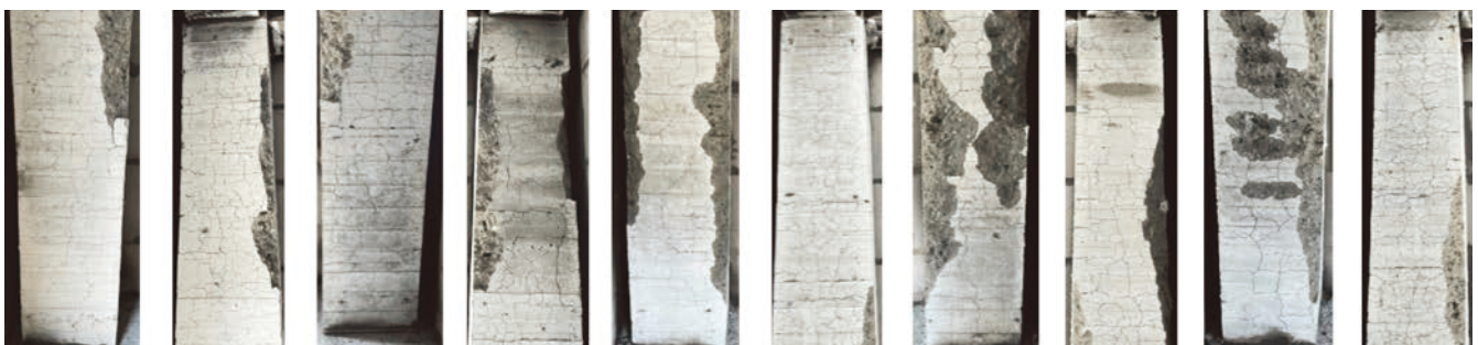
圖 13 F 試體火害後柱表面裂縫及混凝土剝落
