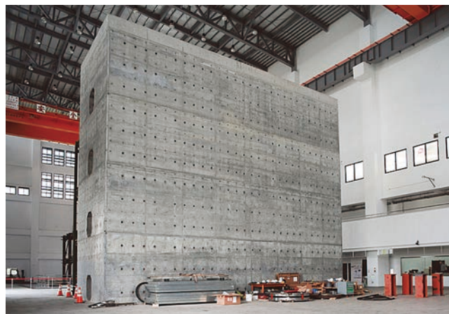
圖 2 反力牆與強力地板測試系統
