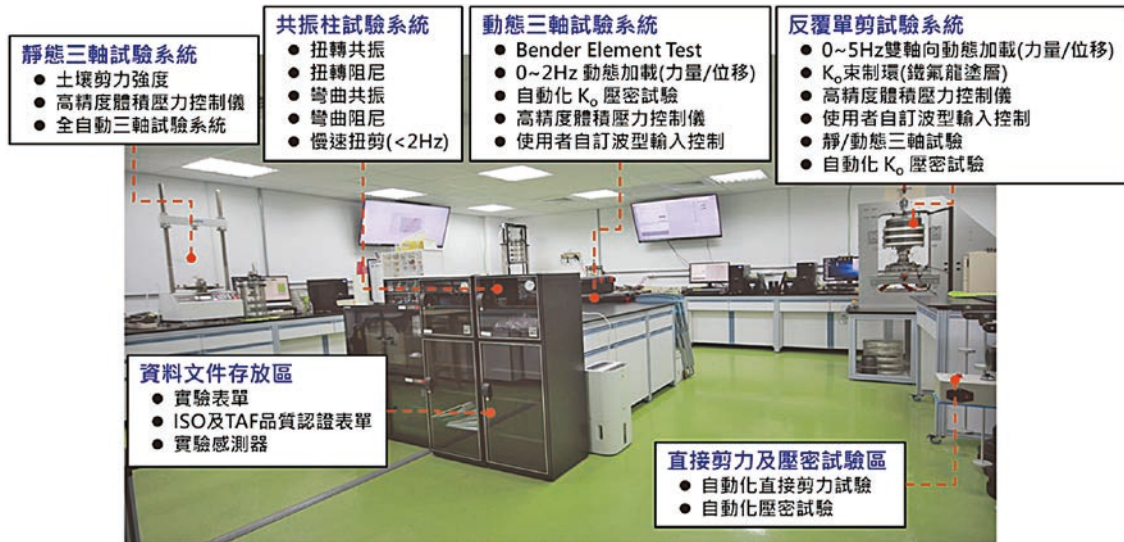
圖 8 土壤力學實驗室具備完整土壤靜態、動態力學及物性實驗能量
