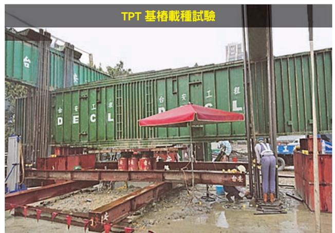
圖 11 現地場鑄基樁載重試驗圖資
