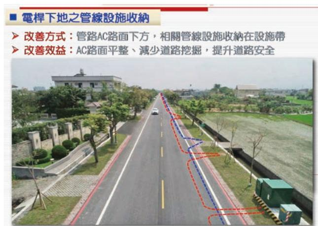
圖 15 AC 路面「零孔蓋」
