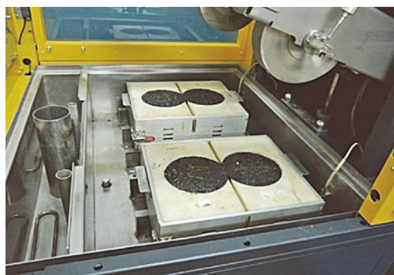
圖 6 車轍輪跡試驗儀器及試體放置
