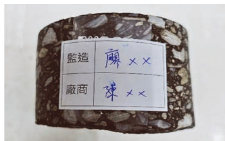
圖 10 RFID 技術應用於瀝青混凝土取樣送驗
