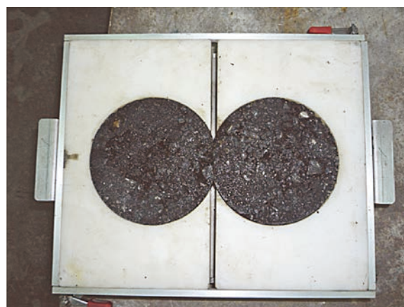
圖 5 漢堡車轍輪跡試驗 8 字形試體及試模
