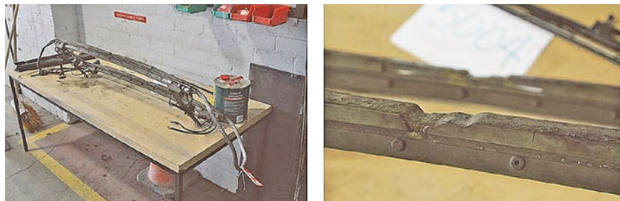
圖 10 弓網接觸不佳可能使集電弓碳刷不均勻耗（國外示意圖）
