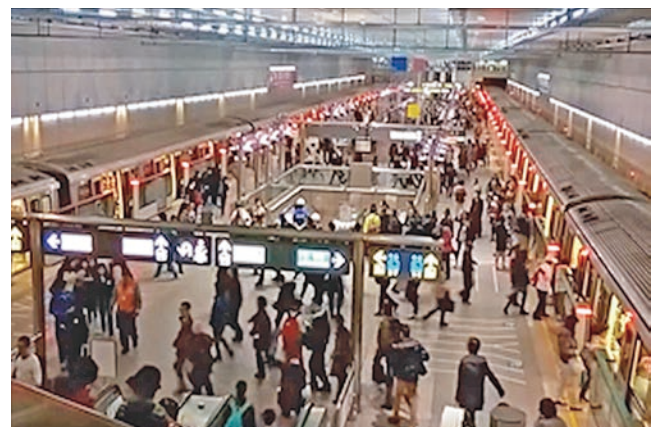
圖 5 不同線兩部列車同方向同時到達月台之轉乘方式
