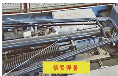
圖 9 集電弓上舉力與張緊彈簧示意圖
